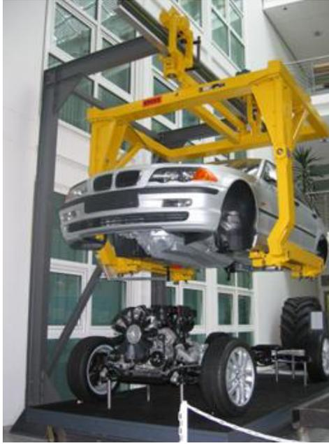
in der Magistrale vor dem Institut MW 5 (Bild 3): Zu sehen ist die „Hochzeit“ von Fahrwerk und Karosserie eines BMW 3er Touring an einer Elektrohängebahn.
